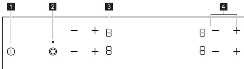
Spotrebič sa ovláda senzorovými tlačidlami. Zobrazenia, ukazovatele a zvuky vám oznámia, ktoré funkcie sú zapnuté.
